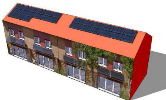
Figure 15 : modèle 3D d'une intégration possible de 10 kWc de photovoltaïque aux 4 maisons accolées bretonnes
