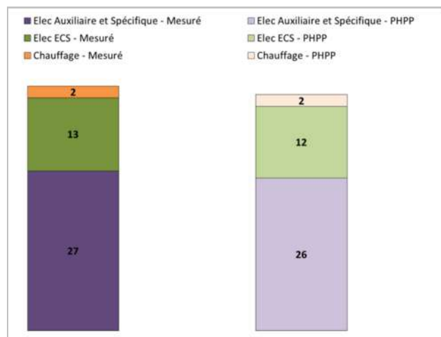
Figure 3 : Consommations d'énergie finale annuelles mesurées et projetées des 4 maisons accolées en kWh/(m².an). Période de Septembre 2011 à Août 2012
