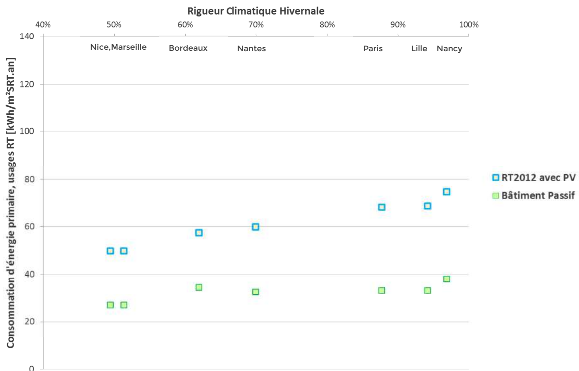
Figure 26 : Consommation d'énergie primaire pour les usages réglementés, bâtiments résidentiels types au standard Bâtiment Passif et RT2012, selon la rigueur de l'hiver, de Nice à Nancy. Calcul selon THBCE.
